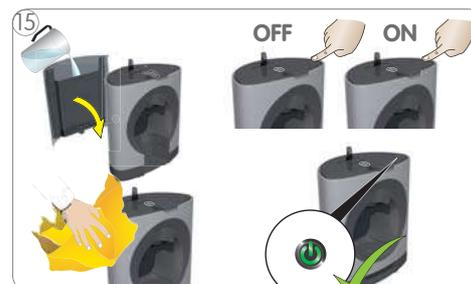
15 Riempire il serbatoio con acqua potabile fresca e inserirlo nella macchina. Pulire la macchina con uno straccetto umido. Asciugarla in seguito con uno straccetto asciutto. Spegnere la macchina. Poi accendere la macchina. Il pulsante di accensione e spegnimento inizia a lampeggiare di colore verde.
