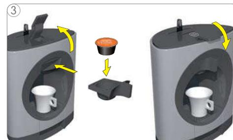
3 Aprire la leva di blocco ed estrarre il supporto per capsule. Inserire una capsula nel supporto e inserirlo nuovamente nella macchina. Chiudere la leva di blocco.
