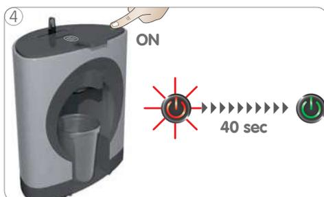
4 Accendere la macchina. Il pulsante di accensione e spegnimento inizia a lampeggiare in rosso quando la macchina si sta scaldando per circa 40 secondi. In seguito il pulsante si fissa sul verde e la macchina è pronta per l'uso.
