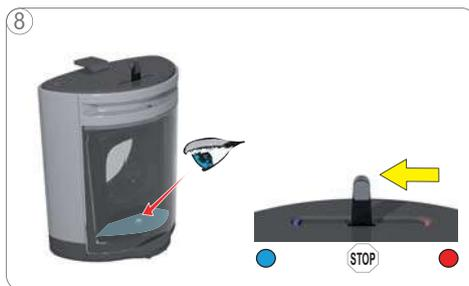
Dopo aver svuotato il serbatoio dell'acqua, spostare la leva di selezione in posizione "STOP".
