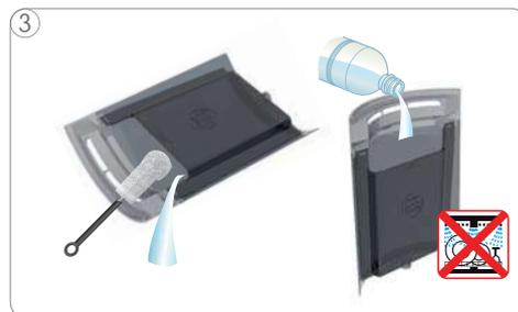
3 Risciacquare e pulire il serbatoio dell'acqua. Riempirlo in seguito con acqua potabile fresca e inserirlo nella macchina. Il serbatoio dell'acqua non può essere lavato nella lavastoviglie!
