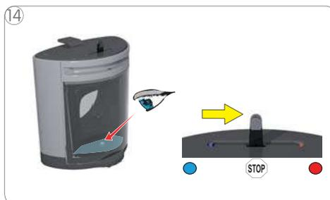
14 Controllare a livello visivo quando il serbatoio è vuoto. Spostare la leva di selezione in posizione "STOP".
