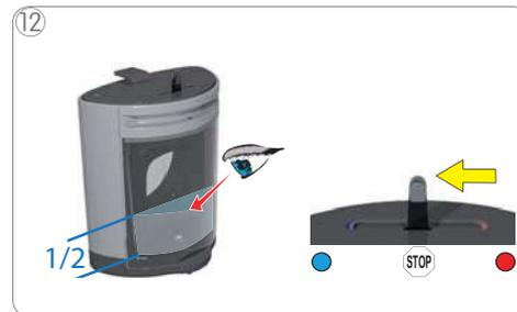
12 Controllare a livello visivo se il serbatoio è semi pieno. Spostare la leva di selezione in posizione "STOP".
