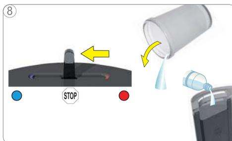
8 Dopo circa 60 secondi spingere la leva in posizione di arresto. Svuotare il bricco e riempire con acqua fresca e potabile.
