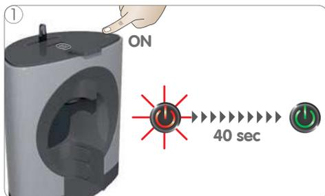
1 Accendere la macchina. Il pulsante di accensione e spegnimento inizia a lampeggiare in rosso quando la macchina si sta scaldando per circa 40 secondi. In seguito il pulsante si fissa sul verde e la macchina è pronta per l'uso.
