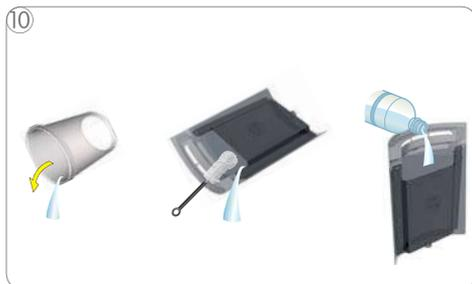
10 Svuotare il recipiente e il serbatoio dell'acqua. Pulire il serbatoio dell'acqua con una spazzola. Riempirlo in seguito con acqua potabile fresca e inserirlo nella macchina.
