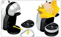
Posizionare la griglia raccogligocce sullo sgocciolatoio. Inserire in seguito il vassoio raccogligocce nella posizione desiderata. Pulire la macchina con uno straccetto umido. Asciugarla in seguito con uno straccetto asciutto.
