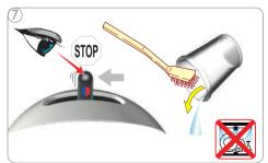
Aspettare che la leva ritorni alla posizione iniziale e l'erogazione si fermi automaticamente. Svuotare e pulire il recipiente.
