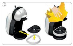
Posizionare la griglia raccogligocce sul vassoio raccogligocce. Inserire in seguito il vassoio raccogligocce nella posizione desiderata. Pulire la macchina con uno straccetto umido. Asciugarla in seguito con uno straccetto asciutto
