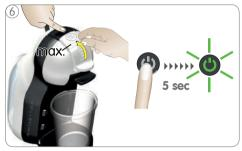
Spingere la barra di selezione dell'erogazione fino al livello massimo di tacche. Premere e mantenere premuto il pulsante di accensione e spegnimento per almeno 5 secondi. Il pulsante di accensione e spegnimento inizia a lampeggiare in verde e la macchina passa alla modalità di decalcificazione.
