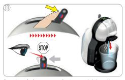
Spostare la leva verso destra per iniziare il risciacquo. Aspettare che la leva ritorni alla posizione iniziale e l'erogazione si fermi automaticamente.
