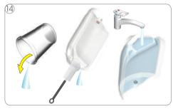
Svuotare e pulire il recipiente. Risciacquare e pulire il serbatoio dell'acqua. Riempirlo in seguito con acqua potabile fresca e inserirlo nella macchina.
