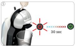
Accendere la macchina. Il pulsante di accensione e spegnimento inizia a lampeggiare in rosso quando la macchina si sta scaldando per circa 30 secondi. In seguito il pulsante si fissa sul verde e la macchina è pronta per l'uso.
