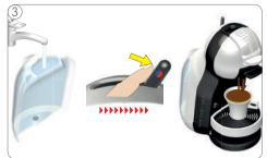
Controllare se c'è dell'acqua nel serbatoio: in caso negativo, riempire e spostare nuovamente la leva nella posizione freddo/caldo per proseguire la preparazione; se il serbatoio è pieno, procedere come seque:
