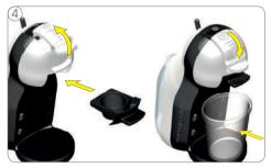
Aprire la leva di blocco e inserire il supporto per capsule vuoto. Chiudere la maniglia di blocco. Collocare un recipiente vuoto da 1 litro sotto l'erogatore.
