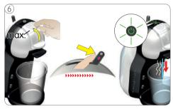
Selezionare il massimo livello sul display a barre. Spostare la leva di selezione a destra per iniziare il ciclo di pulizia.
