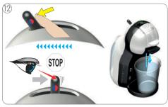
Spostare la leva verso sinistra per iniziare il risciacquo. Aspettare che la leva ritorni alla posizione iniziale e l'erogazione si fermi automaticamente.
