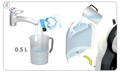
Mescolare 0,5 l di acqua con il contenuto di una busta di soluzione decalcificante liquida. Versare la soluzione decalcificante nel serbatoio dell'acqua e inserirlo nella macchina.
