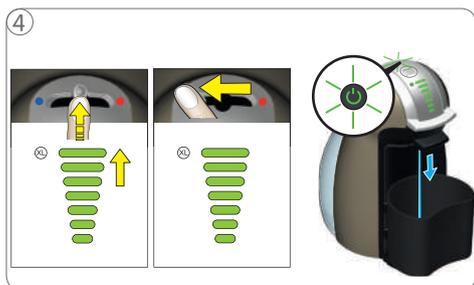
4 Avviare il risciacquo con acqua fredda: Spingere la leva verso l'alto fino alla visualizzazione del livello massimo di tacche illuminate. Spostare la leva verso sinistra per iniziare il processo con acqua fredda.
