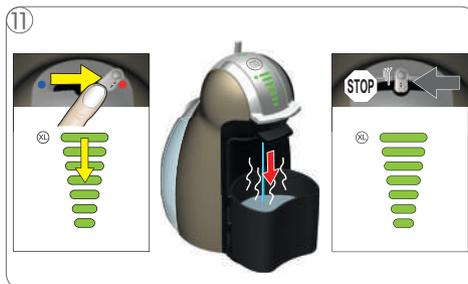
11 Spostare la leva verso destra per iniziare il risciacquo. Lo schermo a barre inizio il conto alla rovescia. Aspettare che la leva ritorni alla posizione iniziale e l'erogazione si fermi automaticamente.
