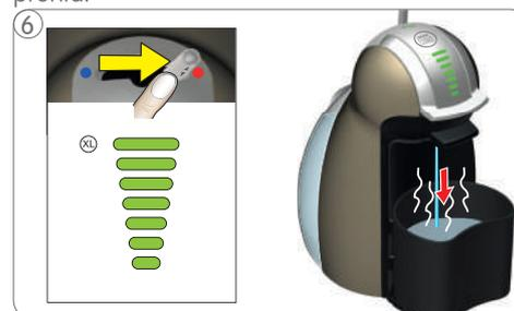
6 Continuare il risciacquo con l'acqua calda: Spingere la leva verso l'alto fino alla visualizzazione del livello massimo di tacche illuminate. Spostare la leva verso sinistra per iniziare il processo con acqua calda.
