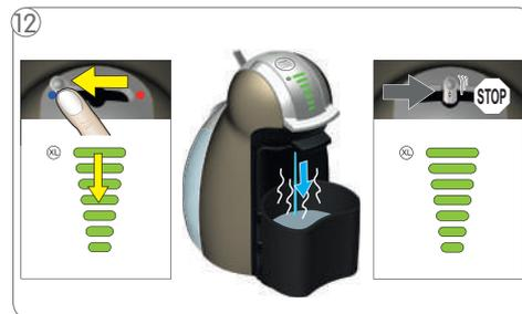
12 Spostare la leva verso sinistra per iniziare il risciacquo. Lo schermo a barre inizio il conto alla rovescia. Aspettare che la leva ritorni alla posizione iniziale e l'erogazione si fermi automaticamente.
