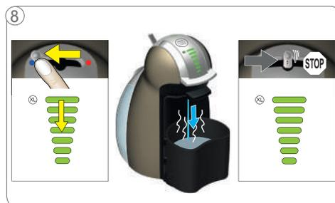
Spostare la leva a sinistra. Lo schermo a barre inizia il conto alla rovescia. La macchina decalcifica con un'operazione di avvio/arresto per circa 2 minuti. La leva torna nella posizione iniziale.
