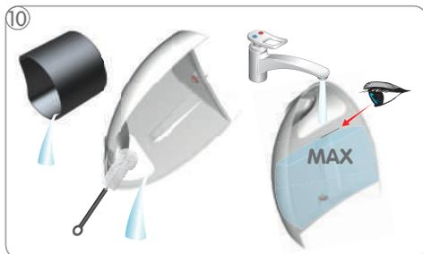
10 Svuotare e pulire il contenitore delle capsule. Risciacquare e pulire il serbatoio dell'acqua. Riempirlo in seguito con acqua potabile fresca e inserirlo nella macchina.
