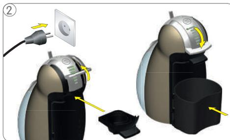
2 Aprire la leva di blocco e inserire il supporto per capsule vuote. Chiudere la leva di blocco. Collocare un recipiente vuoto da 1 litro sotto l'erogatore. Collegare la spina di alimentazione alla presa di corrente.
