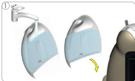
1 Risciacquare innanzitutto il serbatoio dell'acqua. Riempire il serbatoio con dell'acqua fresca e inserire il serbatoio nella macchina.
