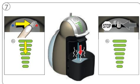
Spostare la leva verso destra. Lo schermo a barre inizia il conto alla rovescia. La macchina decalcifica con un'operazione di avvio/arresto per circa 2 minuti. La leva torna nella posizione iniziale.
