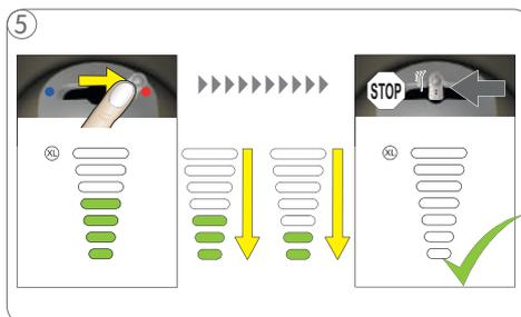
5 Muovere la leva verso destra per la preparazione di bevande calde, e verso sinistra per la creazione di bevande fredde. La preparazione della bevanda inizia. L'illuminazione delle tacche svanisce progressivamente. L'erogazione si ferma automaticamente. L'estrazione dell'acqua si può fermare manualmente rimettendo la rotella di selezione in mezzo.
