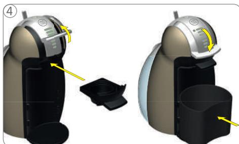
4 Aprire la leva di blocco e inserire il supporto per capsule vuoto. Chiudere la leva di blocco e posizionare il recipiente per le capsule usate sotto l'ugello di distribuzione.
