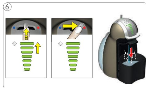
6 Sciacquare la macchina come segue: spingere la leva verso l'alto fino alla visualizzazione del livello massimo di tacche illuminate e spostare la leva verso destra. La macchina inizia il risciacquo. L'illuminazione delle tacche svanisce progressivamente.
