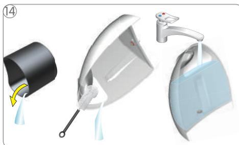
14 Svuotare e pulire il contenitore delle capsule. Risciacquare e pulire il serbatoio dell'acqua. Riempirlo in seguito con acqua potabile fresca e inserirlo nella macchina.
