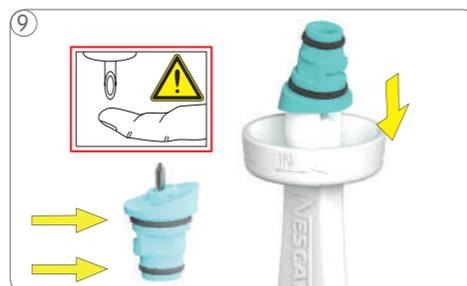
Verifica che entrambi gli aghi di pulizia siano intatti e si trovino nel posto giusto sull'iniettore. Mettere l'iniettore sullo strumento iniettore.
