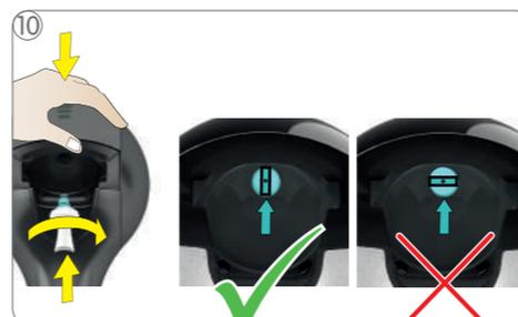
Inserire dal basso l'iniettore nell'apertura della macchina. Sostenere l'iniettore con la mano. Ruotare l'iniettore in senso orario fino al blocco in posizione. Seguire le istruzioni in "8. DECALCIFICARE ALMENO OGNI 3 – 4 MESI" a pagina 13.
