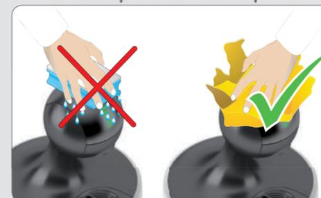
⚠ Non usare mai una spugna bagnata. Usare solo un panno umido per pulire la parte superiore della macchina.
