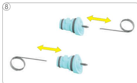
Inserire l'ago di pulizia nell'iniettore per disintasarlo. Se non è possibile, preparare una soluzione decalcificante con un sacchetto e 0,5 lt. di acqua potabile. Mettere l'iniettore nella soluzione decalcificante.
